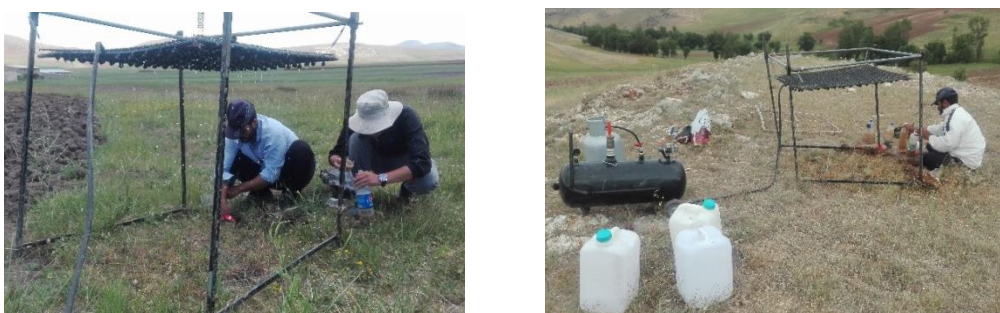
شکل (۲) تصاویری از نحوه‌ی برداشت نمونه‌های رواناب و رسوب در عرصه با استفاده از شبیه‌ساز باران
