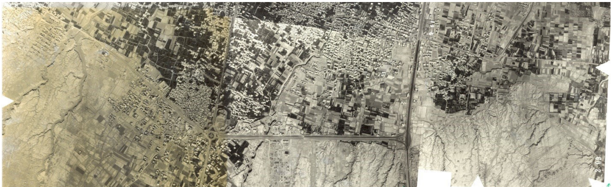
تصویر شماره ۴: عکس هوایی سال ۱۳۳۵ میبد. نحوه استقرار رشته قنات‌ها در راستای مسیر آبراهه‌ها که به صورت عمود بر تراس رسی میبد واقع شده‌اند؛ مأخذ: آرشیو پایگاه پژوهشی میبد، ۱۳۹۵
